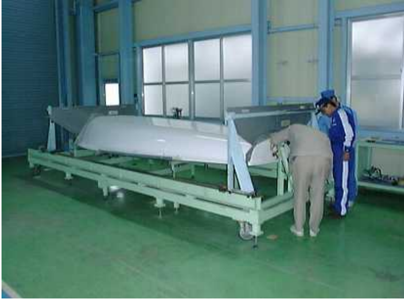
船型計測の様子 水平にセットした計測台に艇を乗 ベースラインを設定 テンプレート(ISA F 支給品)を
