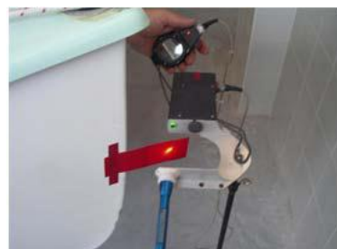
非常に特殊な道具： スィングテスト機材 電池起動装置に連結された電子タイマー
