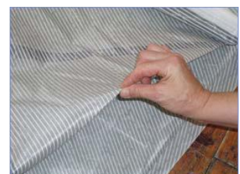
ちょうどよい張力をかけて 横方向のしわを取り除く
