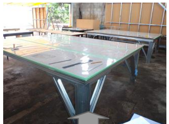
3.5 × 2.5mのテーブル、完全に水平で滑らかである事。可能であれば、計測台は下側に補強を入れた1枚盤で制作する事。
